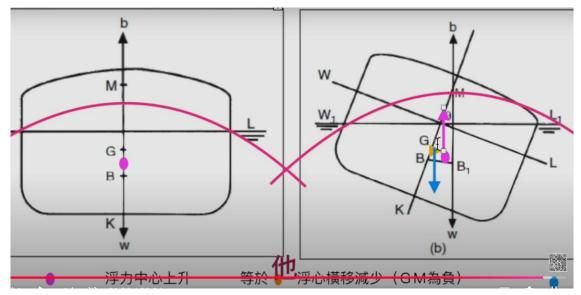
隨著波浪在變動,現在比較左邊跟右邊的浮心,就發現了浮心怎麼樣?又跑到右邊去了,這時候 GM 就又回正了,所以船遇到波浪過去,讓船一下有左傾的力矩,一下又有右傾的力矩,造成船隻不規則的擺動,好像魚在水裡面遊一樣,一下子偏左邊一下偏右邊,船就是這樣,是在海裡面游泳,尤其是越大的船高張力鋼的船就越明顯,船頭船尾不同步時,造成船身抖動。
