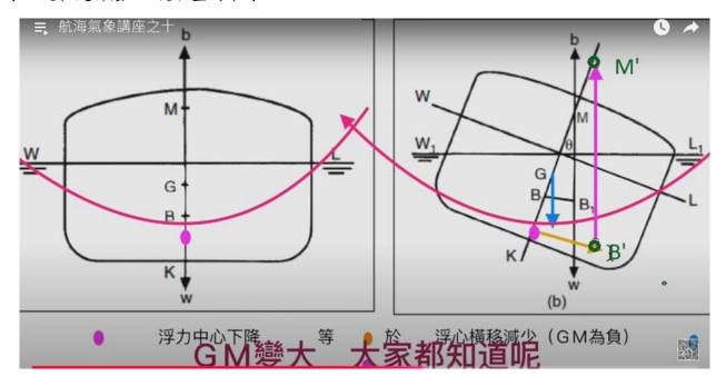
波浪,它在海裡面不是什麼平的,所以現在變成新的水線,就是這條紅線,加上它下面船體所圍住的體積,就是新的浮力來源,所以船怎麼樣?船的浮心就變了。船的浮心下降,本來在這邊B的位置,因為現在這一部分的船體的水下體積變小了,所以浮心就跟著下降,如果它下降到粉紅點的位置,當然圖是畫得有點誇張,造成本來在B這邊的浮心下降,浮心下降以後,船同樣吃到波浪向右傾,它的浮心要向哪裡?B'
