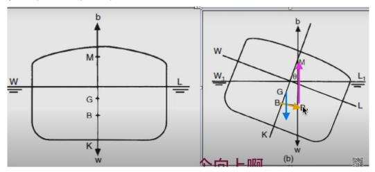
現在來談一談在風浪之中穩定度的變化首先,還是由靜態靜水的穩定度來講解,船體泡在水線下的體積,提供它的浮力。這條 WL line 水平線就是水線,所以在這個 WL line 下面跟船體的外板圍起來的這一塊空間,就是它浮力的來源。浮力的體積的中心,就叫浮心叫 buoyancy Center (B),G 是重心,M 是穩心(浮心 B 因波浪運動產生位置變動,其垂線通過船中心線的一點)。
